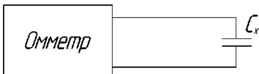
**Рисунок 3 – Схема измерения эквивалентного последовательного сопротивления переменному току**
