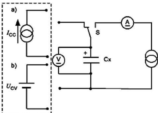
$C_x$  – испытываемый конденсатор;
