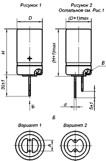
Малогабаритные суперконденсаторы специального назначения:
