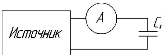
**Рисунок 4 – Схема измерения тока утечки**
