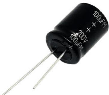
Полярные, постоянной емкости, для работы в цепях постоянного и пульсирующего тока РЭА. Предназначены для внутреннего монтажа с требованиями стойкости к повышенной влажности воздуха 98% при температуре 35°C. Уплотненные. В изолированном корпусе с радиальными проволочными выводами.
